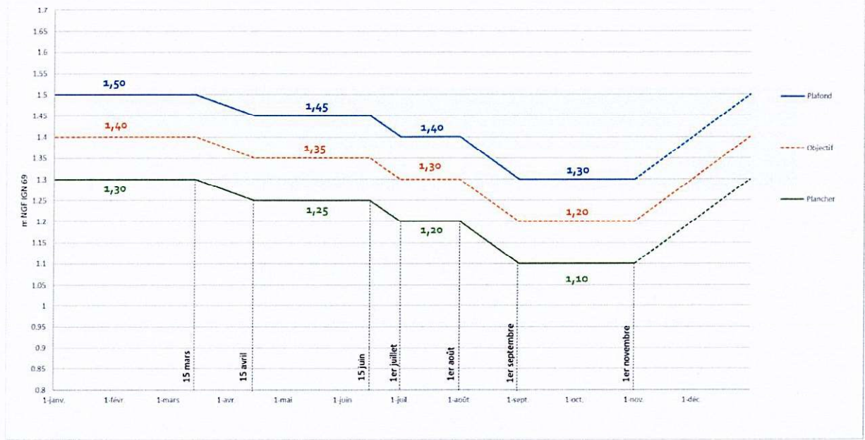
Suivi des niveaux d'eau sur l'UHC Mouilleped - échelle et sonde situées à l'île Bernard
